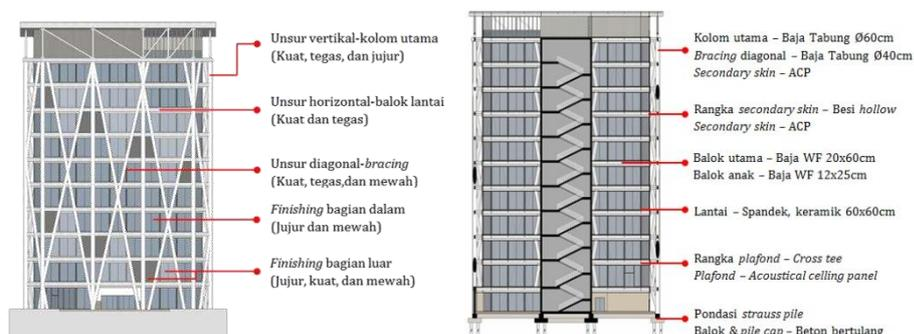
Gambar 7. Modul *Bracing* Eksterior dan Interior
