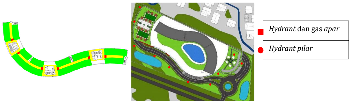
Gambar 6. Penempatan Hydrant Pilar, dan Gas Apar (Sumber: Hasil desain, 2015)
