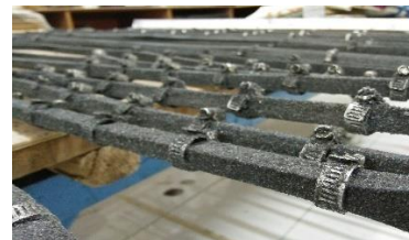
Gambar 4. Hasil pemberian lapisan pada tulangan bambu.
