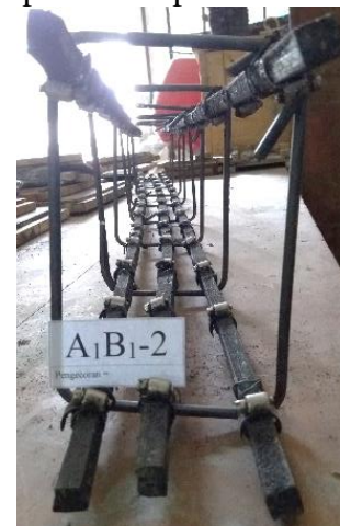
Gambar 4. Pemasangan Tulangan Balok
