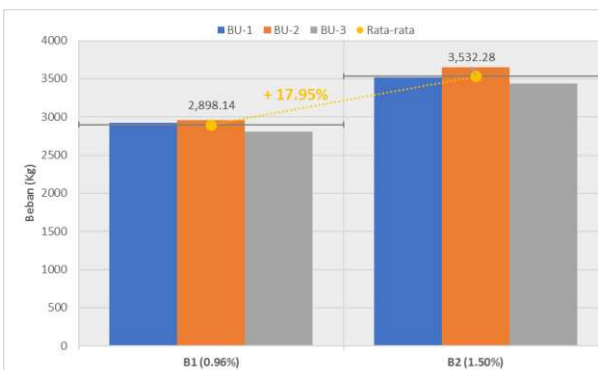
Gambar 17. Perbandingan Beban pada Benda Uji A 2 (Klem Selang Jarak 6 cm)
