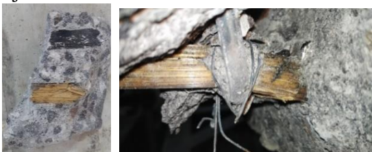
Gambar 25. Keruntuhan Lekatan pada Balok
