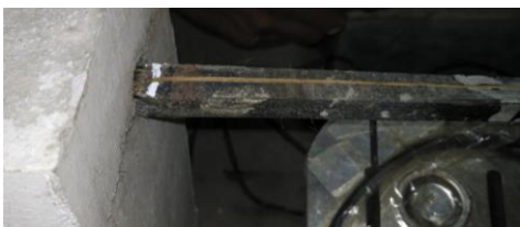
Gambar 22. Keruntuhan kombinasi geser dan putus (bambu pecah tapi tidak terbelah)
