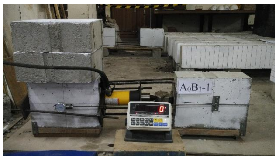
Gambar 4.1 Pengujian Benda Uji Pull Out
