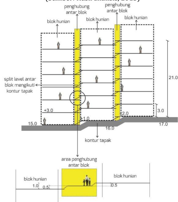
Gambar 6. Peletakan Blok Hunian Mengikuti Kontur Tapak
