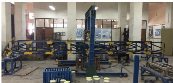
Gambar 3.2 Perletakan Model Jembatan pada Loading Frame tampak samping
