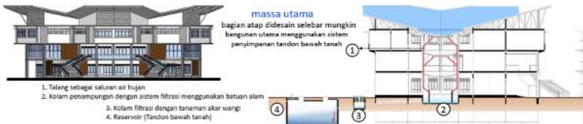
Gambar 6. Sistem Penampungan Air Hujan pada Bangunan Utama
