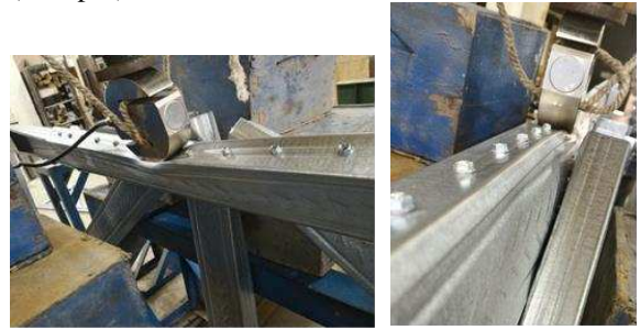
Gambar 12 Model keruntuhan pada model 3
