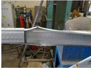
Gambar 10 Model keruntuhan pada model 2
