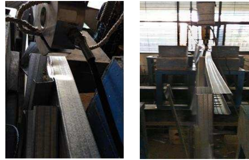
Gambar 8 Model 1 mengalami keruntuhan di profil
