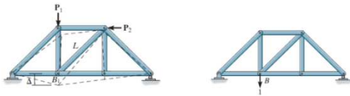
Gambar 2 Lentutan pada rangka batang Sumber: Hibbeler (2002)
