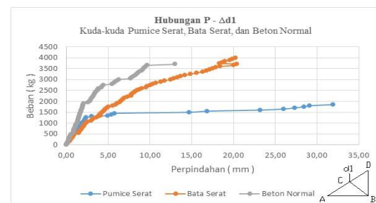
Gambar 7 Grafik Hubungan Antara Beban (P) Dan Perpindahan ( \Delta d1 ) di d1 (Pumice Serat, Bata Serat, dan Beton Normal)
