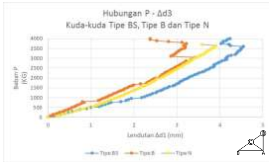
Gambar 7 Grafik hubungan beban (P) dan lendutan rata-rata ( \Delta d3 ) kuda-kuda tipe BS, tipe B dan tipe N
