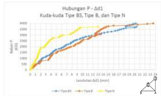
Gambar 5 Grafik hubungan beban (P) dan lendutan rata-rata ( \Delta d1 ) kuda-kuda tipe BS, tipe B dan tipe N
