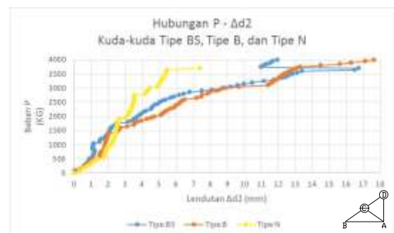
Gambar 6 Grafik hubungan beban (P) dan lendutan rata-rata ( \Delta d2 ) kuda-kuda tipe BS, tipe B dan tipe N
