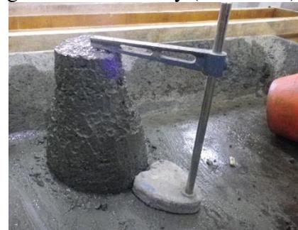
Gambar 4.4 Pengujian slump
