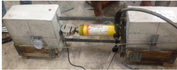
Gambar 4.1 Pengujian Pull Out
