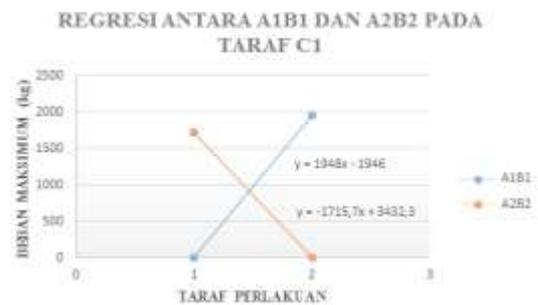
Gambar 4.7 Hubungan regresi untuk interaksi A1B1 dan A2B2
