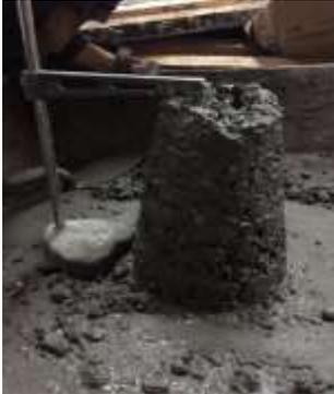
Gambar 4.1 Pengujian *Slump*
