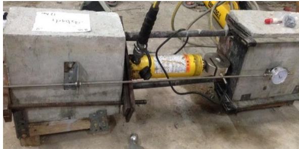
Gambar 4.1 Pengujian Benda Uji Pull Out
