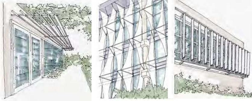
Gambar 3. Contoh *Shading Device* untuk Sisi Selatan (Kiri), Utara (Tengah), Barat dan Timur (Kanan)
