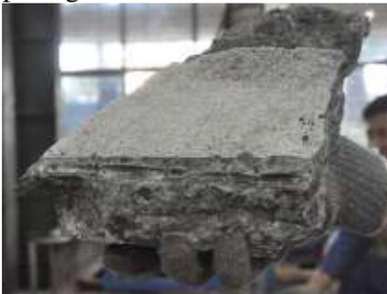
**Gambar 4.2** Lekatan bata ringan dengan beton
