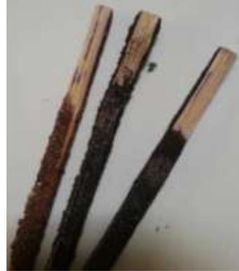
**Gambar 4.1** Pengujian daya resap air pada bambu
