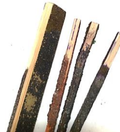
Gambar 4.1 Pengujian resapan bambu terhadap air
