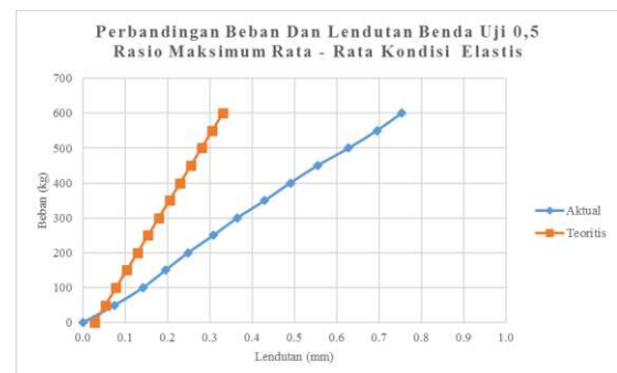
Gambar 4.8 Grafik perbandingan beban dan lendutan benda uji rasio 0,5 rasio maksimum ( 0,5 \rho_{maks} ) rata – rata kondisi elastis
