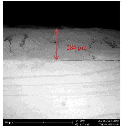
Gambar 6. Gambar ketebalan 2 lapis masker TiO 2 dengan perbesaran 250 kali
