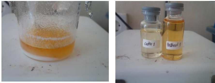
Gambar 8. Biodiesel dari hasil transesterifikasi minyak castor terkatalisis CaO/kaolin.
