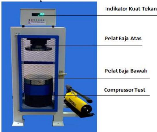
Gambar 3. Alat pengujian kuat tekan
