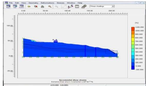
Gambar *Incremental Shear Strains Tahap Cutting + Perkuatan Gabion dan 2 Bored Pile*
