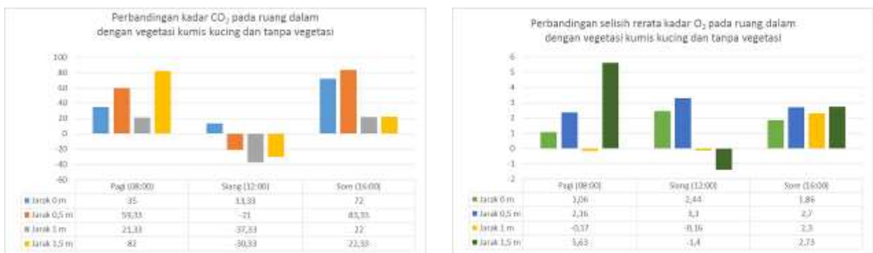
Gambar 9. Grafik Perbandingan Kadar CO 2 dan O 2 pada Ruang Dalam Objek Penelitian dengan Penataan Vegetasi Kumis Kucing (Sumber: Hasil Analisis, 2014)
