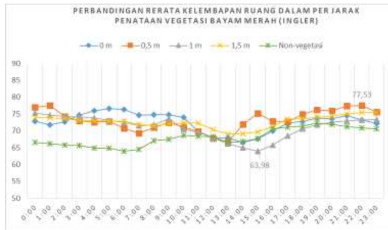
Gambar 8. Rerata Kelembapan Ruang Dalam pada Objek Penelitian dengan 4 Variasi Jarak Penataan Bayam Merah (Sumber: Hasil Analisis, 2014)
