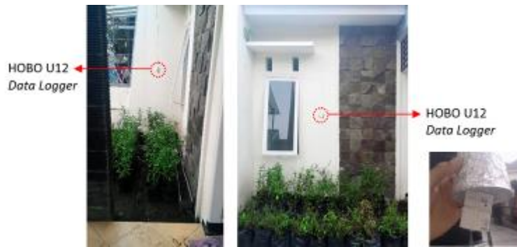
Gambar 2. Posisi Peletakan Alat Ukur Otomatis (HOBO Data Logger)
