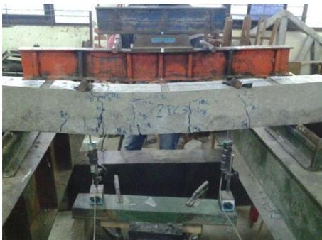
Gambar 4. Pembebanan pada Balok
