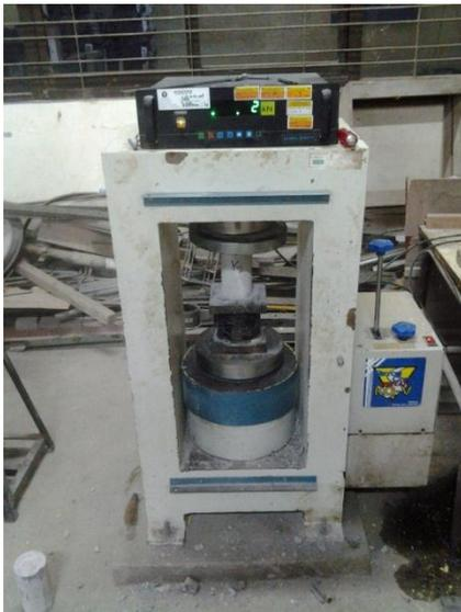
**Gambar 3.** Pengujian Kuat Tekan Silinder
