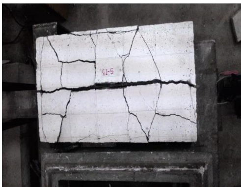
Gambar 7. Pola Keruntuhan Bagian Tarik Plat Beton Lapis Styrofoam
