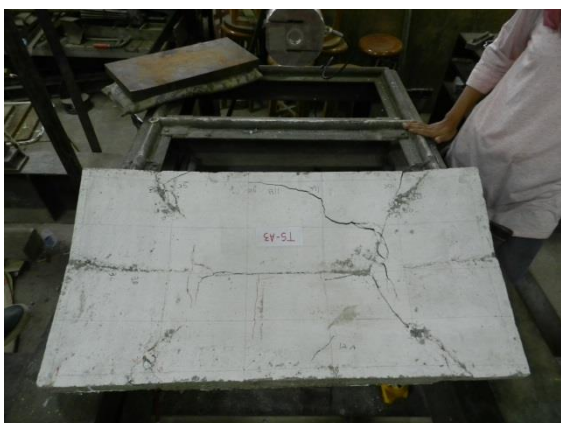
Gambar 8. Pola Keruntuhan Bagian Tekan Plat Beton Tanpa Styrofoam
