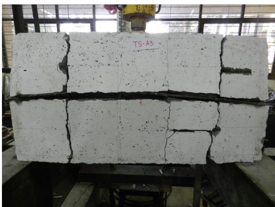
Gambar 9. Pola Keruntuhan Bagian Tarik Plat Beton Tanpa Styrofoam
