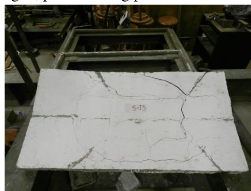
Gambar 6. Pola Keruntuhan Bagian Tekan Plat Beton Lapis Styrofoam
