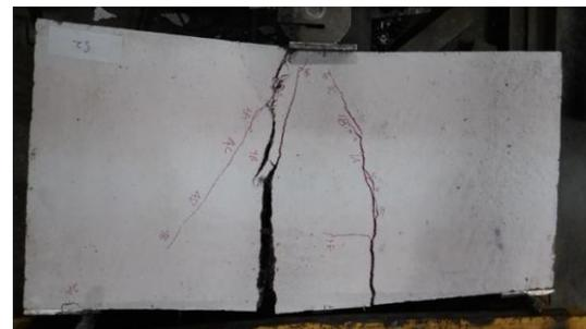
**Gambar 4.6 Model keruntuhan panel dengan Styrofoam**
