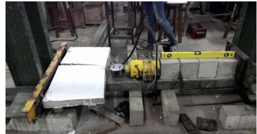
**Gambar 4.1 Rangkaian alat pengujian geser in-plane**
