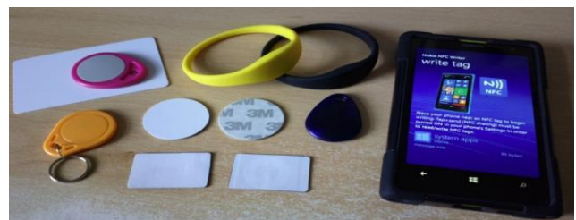
Gambar 1 Contoh berbagai macam bentuk NFC tag
