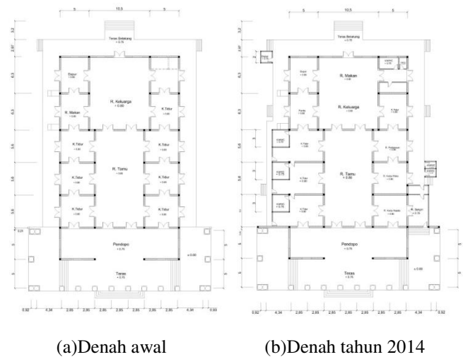
Gambar 1. Perubahan denah Bangunan Bakorwil
