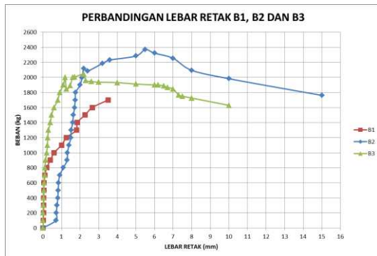
Grafik 3.2 Hubungan Lebar Retak dan Beban Benda Uji B
