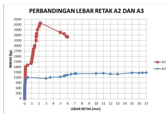
Grafik 3.1 Hubungan Lebar Retak dan Beban Benda Uji A
