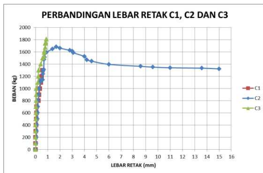
Grafik 3.3 Hubungan Lebar Retak dan Beban Benda Uji C
