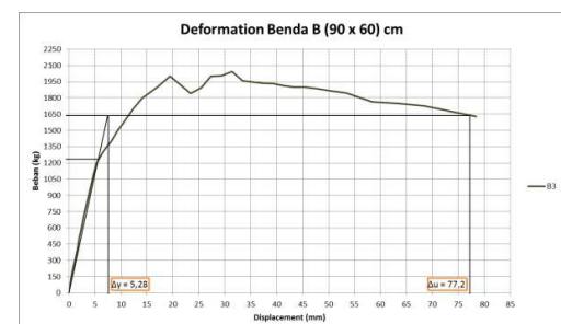
Grafik 11 Hubungan antara P-Δ benda uji B 3
