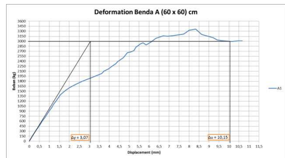
Grafik 5 Hubungan antara P-Δ benda uji A 1
