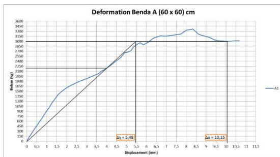
Grafik 4 Hubungan antara P-Δ benda uji A 1
