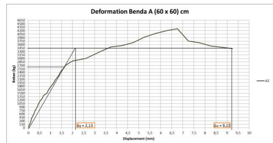
Grafik 6 Hubungan antara P-Δ benda uji A 2
