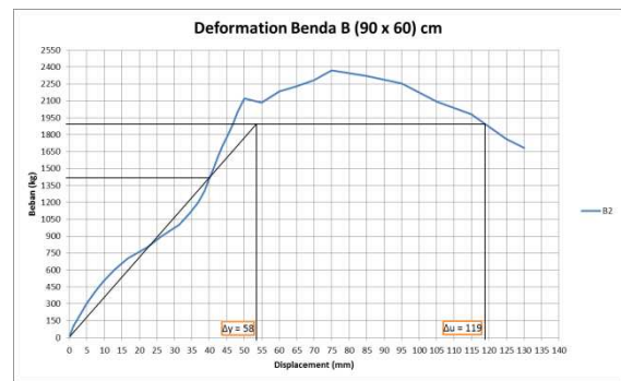
Grafik 9 Hubungan antara P-Δ benda uji B 2
