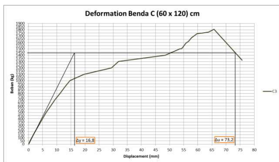
Grafik 17 Hubungan antara P-Δ benda uji C 3
