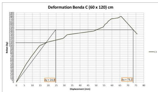
Grafik 16 Hubungan antara P-Δ benda uji C 3
