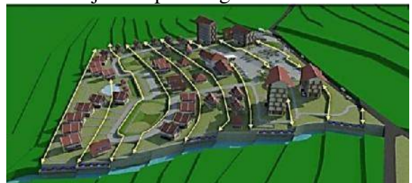
Gambar 25 : Mayoritas menerapkan Dinding Penahan Tanah Miring
