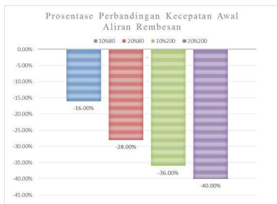
Gambar 3.6 Diagram perbandingan kecepatan awal aliran rembesan benda uji terhadap benda uji normal hari ke-28
