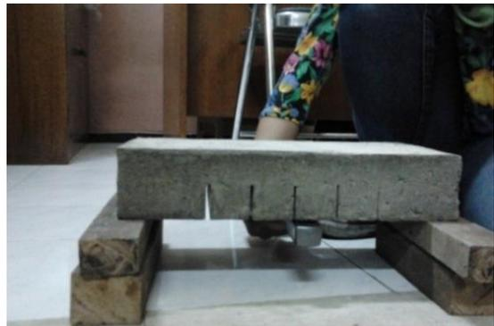
**Gambar 8** Pemindaian pada permukaan beton
