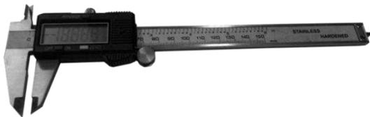
**Gambar 3** Jangka sorong tipe M *digital*
