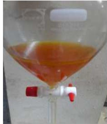
**Gambar 4.** Hasil transesterifikasi menggunakan katalis  $\text{Mg}/\gamma\text{-Al}_2\text{O}_3$
