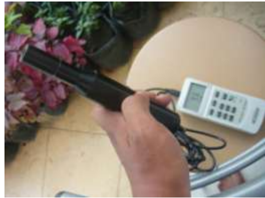
Gambar 3.7 Alat ukur oksigen ( oxygen meter )
