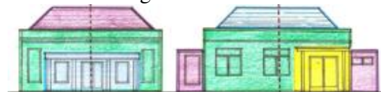
Gambar 13. Tatanan elemen visual (jendela dan pintu) simetris dan asimetris pada tampak bangunan
