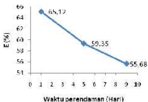
Gambar 5. Efisiensi inhibisi KMK sebagai inhibitor korosi baja lunak dalam H_2SO_4 dengan variasi waktu perendaman
