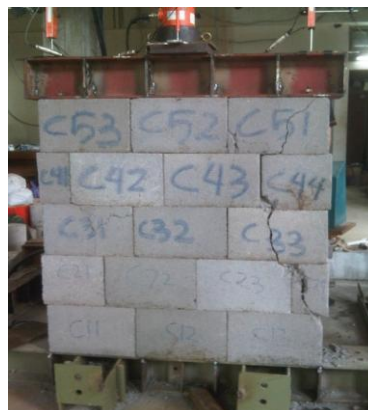
Gambar 8. Tampak Depan Kerusakan Dinding BTPTP
