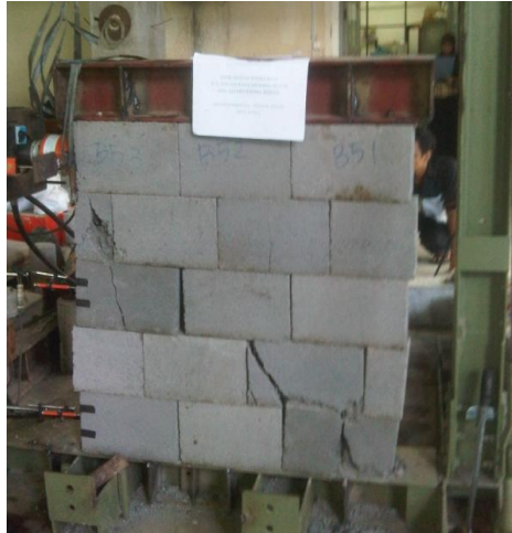
Gambar 14. Tampak Depan Kerusakan Dinding BTPTP
