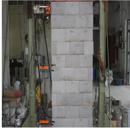
Gambar 19. Setting Alat dan dinding BTPTP ketinggian 2 meter
