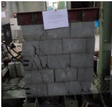
Gambar 16. Tampak Depan Kerusakan Dinding BTPTP
