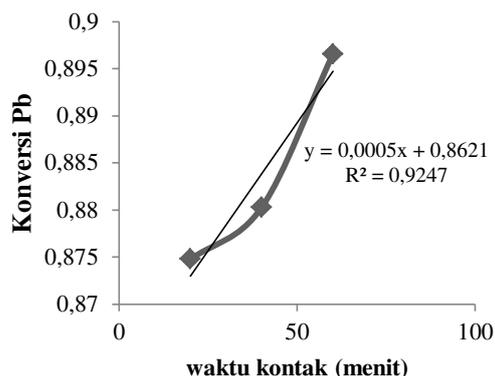
Gambar 12. Kurva waktu kontak vs konversi Pb pada massa 1,5 g
