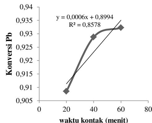
Gambar 13. Kurva waktu kontak vs konversi Pb pada massa 2 g
