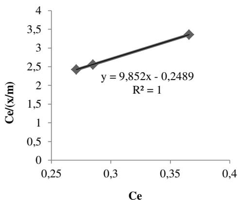
Gambar 7. Kurva isoterm langmuir pada massa 2 g
