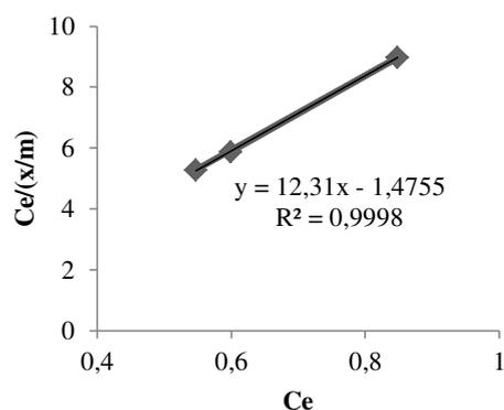
Gambar 5. Kurva isoterm langmuir pada massa 1 g
