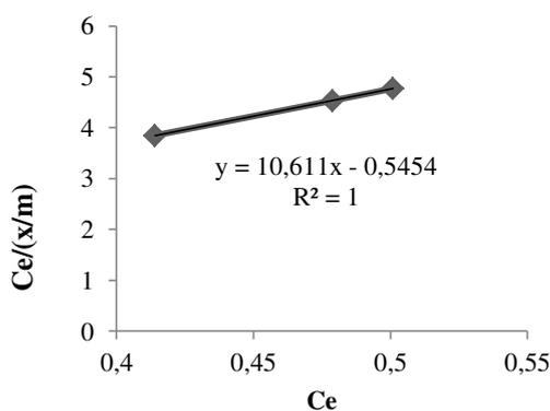
Gambar 6. Kurva isoterm langmuir pada massa 1,5 g
