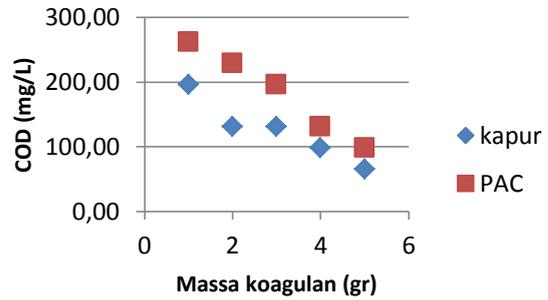
**Gambar 1.** Hubungan COD (mg/L) terhadap Massa Koagulan (gr) pada Sampel Limbah Deterjen Buatan
