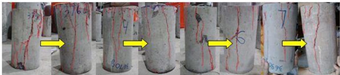
Gambar 3. Pola Retak Benda Uji
