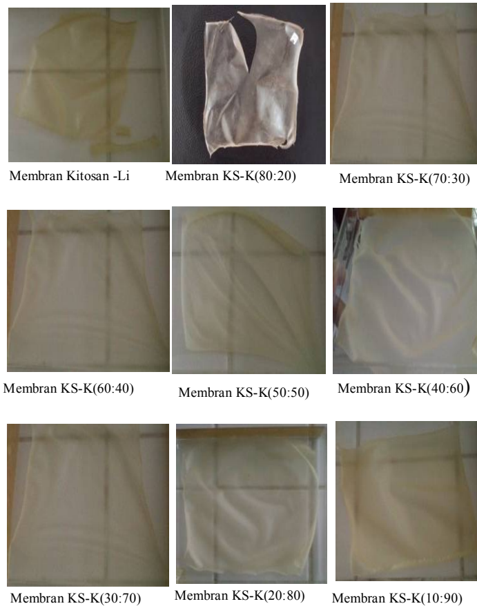
Gambar 2. Membran kitosan suksinat-kitosan dengan berbagai variasi massa dalam % (b/b)
