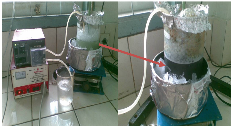
Gambar 1. Foto proses pembuatan NZVI secara presipitasi dengan penambahan stabilizer Cethyl Methyl Ammonium Bromide
