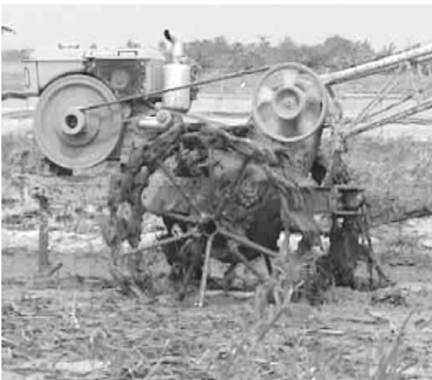
Gambar 9. Perbandingan tanah atau lumpur yang menempel pada roda : a) roda hasil rancangan, b) roda lokal
