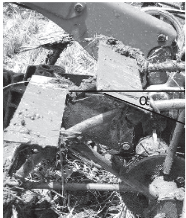
Gambar 7. Permasalahan yang terjadi pada prototipe roda hasil rancangan: (a) kesulitan mengengkol, (b) perubahan sudut kemiringan sirip
