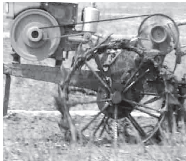
Gambar 9. Perbandingan tanah atau lumpur yang menempel pada roda : a) roda hasil rancangan, b) roda lokal
