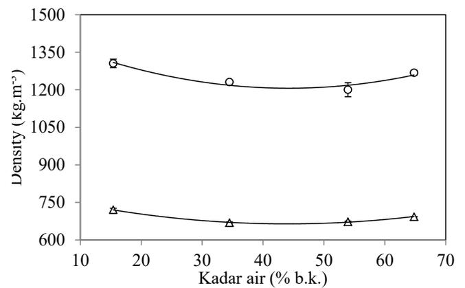
Gambar 6. Pengaruh kadar air terhadap *bulk density* (Δ) dan *true density* (○) biji lada putih.
