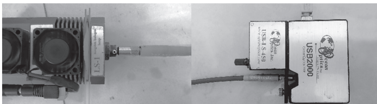
Gambar 2. Posisi pengukuran spektrum daun (kiri) dan spectrometer Vis-NIR (kanan).
