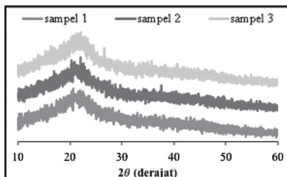
Gambar 3. Hasil Pengujian XRD nanopartikel biomassa rotan metode Herzong 15 menit (a), 30 menit (b) dan 45 menit (c).
