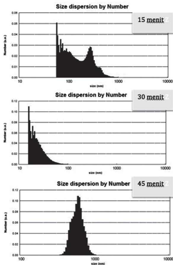
Gambar 1. Grafik pengujian PSA berdasarkan metode cumulant distribusi jumlah (*number*) pada ukuran partikel variasi waktu *milling*.
