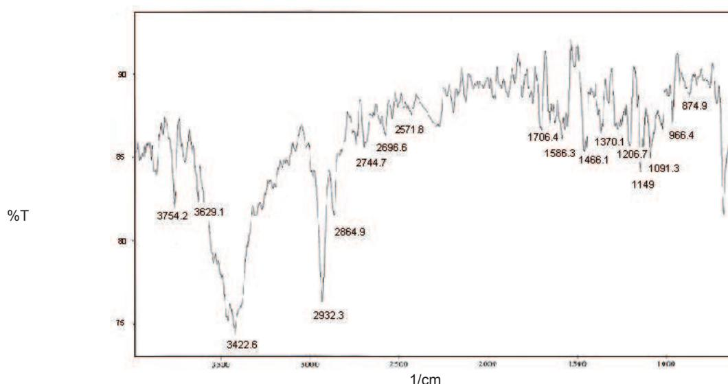
**Gambar 3. Spektrum IR isolat dalam pelet KBr**
