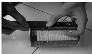
Gambar 5. Mengukur titik waveguide
