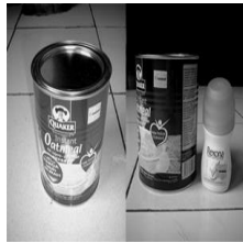
Gambar 2. Kaleng sebagai bahan pembuatan antenna
